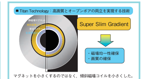
図8 71cmの開口径を実現したVantage Titan 3TのOpen Bore
