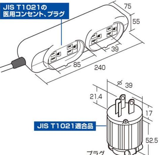
●薬液、輸液などの導電性が高い液体が浸入しにくい横差し構造のため、絶縁劣化による短絡停電を防止します。
