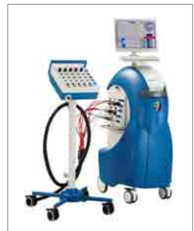
図1 凍結治療器「CryoHit」 高圧気体のエネルギー交換による Joule-Thomson 効果を用いて、凍結と解凍を制御する。
