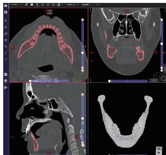
図2 STLファイル出力直前の確認画面 STL出力前にCT画像を確認しながら下顎骨のみのマスク (赤) を作成 (VR表示で表面が少し削れる程度)
