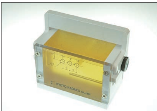
図1 JABTS監修日常点検用体表超音波精度管理ファントム（US-4B）
